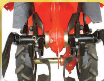
一體式耕耘刀管-堅固耐用 寬度 36cm (1.2 尺)
