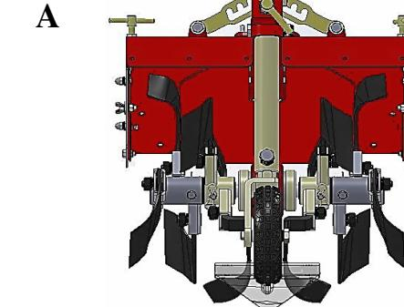
附圖17, 耕耘軸反轉時，培土刀與殘耕犁的裝置方向與方法
