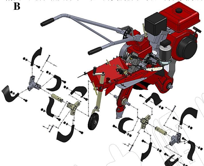
附圖17-1, 耕耘軸反轉時，培土刀的裝置方向與方法
