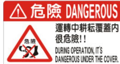
七、操作中引擎排氣口附近溫度高，切勿靠近以免燙傷。此外耕耘刀迴轉時甚為危險，故耕耘部覆蓋內，手腳不可接近。
